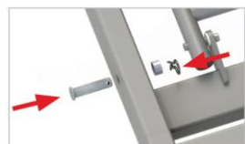
Montaż sworznia, zawleczek 'R' i plastikowej tulei
