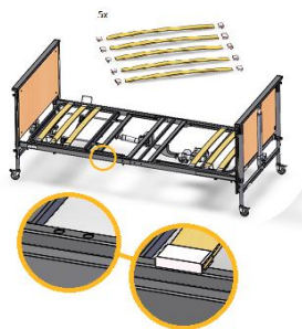
Montaż lamel drewnianych
