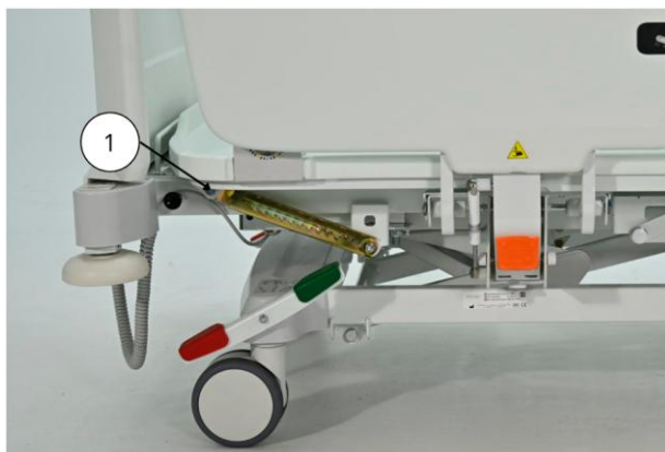
(Rysunek przedstawia ręczną regulację wysokości sekcji nóg)
