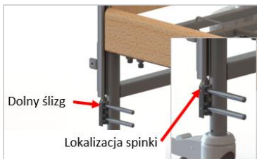
Montaż dolnego ślizgu
