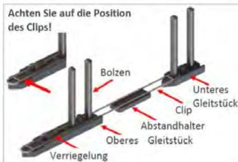
*Gleitsystem mit Abstandshalter (verwendet mit Holzholmen mit einer Höhe von 85, 95 oder 100 mm)*
