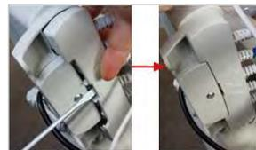
*Aufsetzen der Steckerabdeckung – Steckerabdeckung einrasten lassen*
