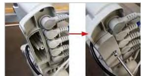
*Aufsetzen der Batterieabdeckung – Befestigen Sie die Batterieabdeckung mit der mitgelieferten Schraube*
