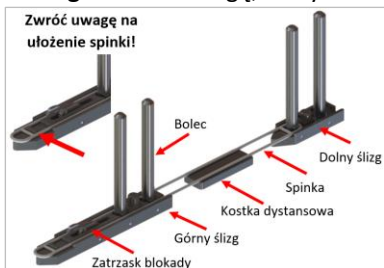
System ślizgów z kostką dystansową (stosowany z poręczami o wysokości 85, 95 lub 100mm)
