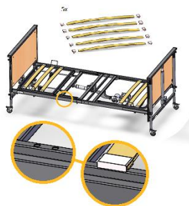
Montaż lamel drewnianych
